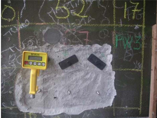
Prova con sonda Windsor
