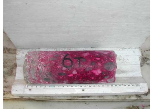
Prova di carbonatazione su campione cilindrico di calcestruzzo
