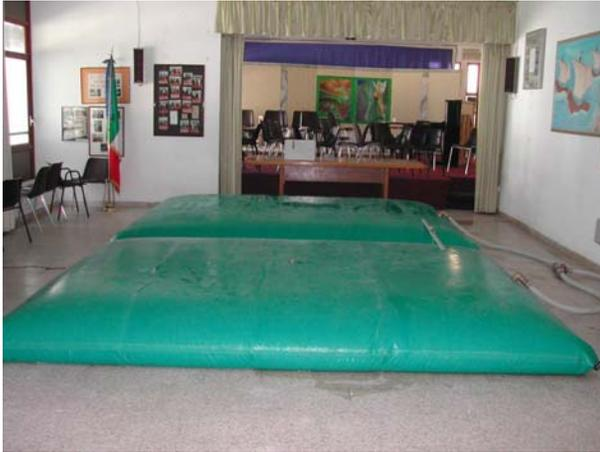
Prova di carico su solaio
